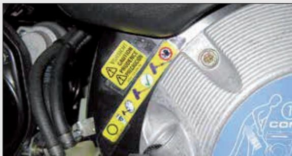
Ist ein Warnaufkleber am Motor verdeckt, (z.B. durch Abdeckung, Kapselung, etc.) muss am Gerät (der Maschine) geprüft werden, ob diese Gefahr weiterhin besteht. Wurde die Gefahr eliminiert entfällt der zusätzliche Warnaufkleber. Besteht jedoch weiterhin die Gefahr muss vom Gerätehersteller ein neuer Warnaufkleber aufgeklebt werden. Der Gerätehersteller ist somit für die richtige Anbringung der Warnaufkleber am Motor und an der Maschine verantwortlich.
