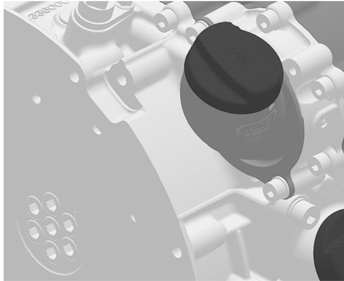
Damit der PTO oben mit Drucköl versorgt werden kann, muss der Gewindestift M6x10 entfernt werden. Die Nichtbeachtung kann zu **schwerwiegenden Motorschäden** führen!
